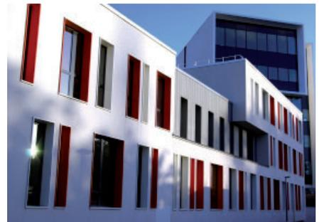
qualité environnementale : objectifs de consommation : 70kWhep/an/m<sup>2</sup> • enveloppe performante : isolation par l'extérieur, ouvertures limitées, brise soleil, vitrages basse émissivité • toiture végétalisée • bâtiment à très forte inertie, principe de free-cooling • chauffage par terminaux radiatifs
